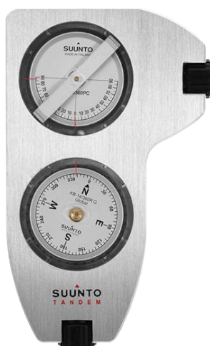
Figura 13. La altura total se midió con mecánico SUUNTO TANDEM. hipsómetro.
